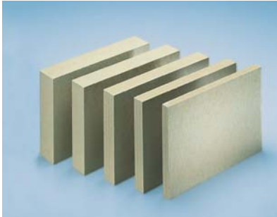
Monolitische houtvezelplaat met een dichtheid van 160\text{kg/m}^3 ( \lambda 0.042) of 185\text{kg/m}^3 ( \lambda 0.046).
