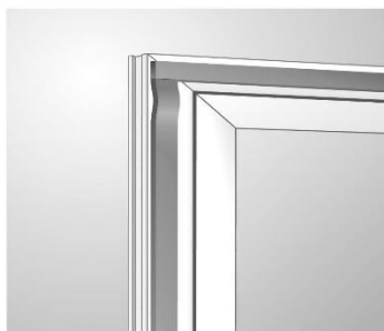
fig. 1 : réalisation de joints au niveau des bandes comprimées
